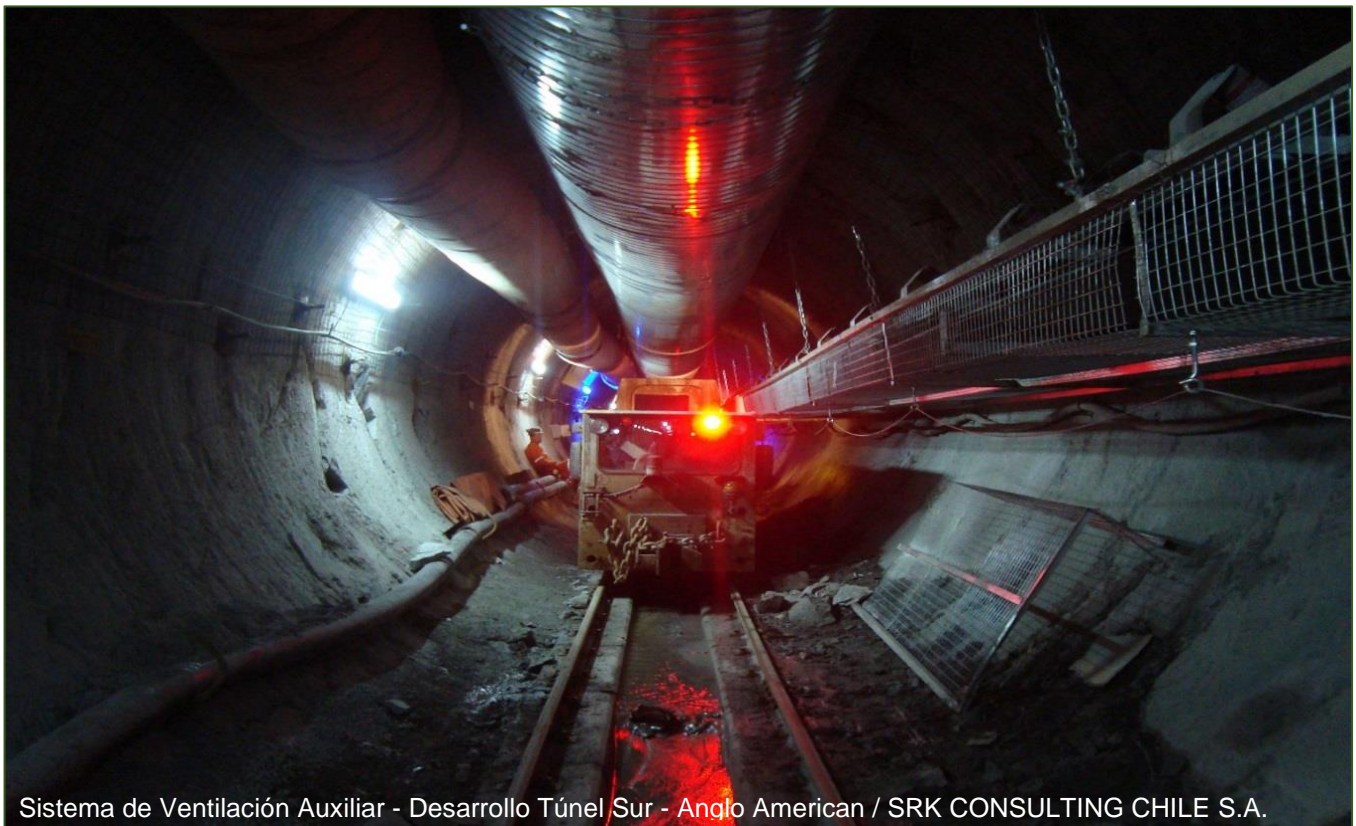
Sistema Ventilac. Desarrollo Nv. Producc. - Proy. Nuevo Nivel Mina, Mina El Teniente / CODELCO - CHILE
